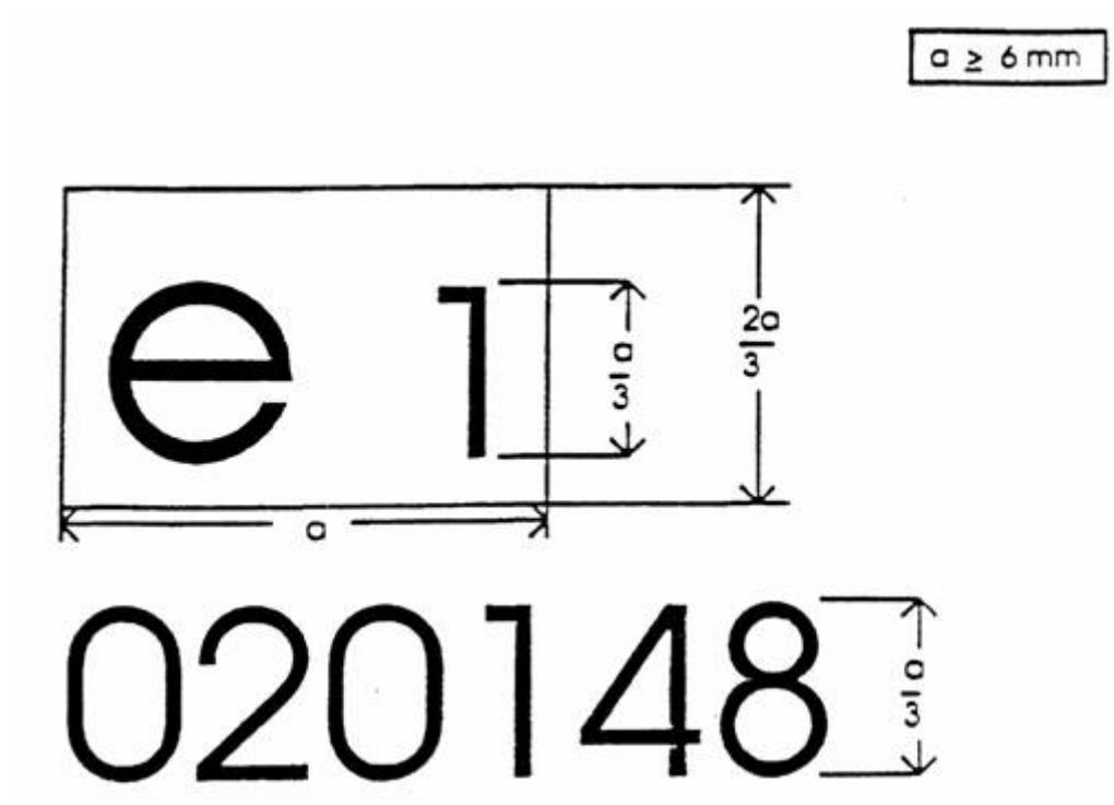
L'unità elettrica/elettronica recante il marchio di omologazione CE sopra riprodotto è un dispositivo omologato in Germania (e1) con il numero di omologazione di base 0148. Le prime due cifre (02) indicano che il dispositivo è conforme ai requisiti della direttiva 75/322/CEE, come modificata dalla direttiva 2000/2/CE.
