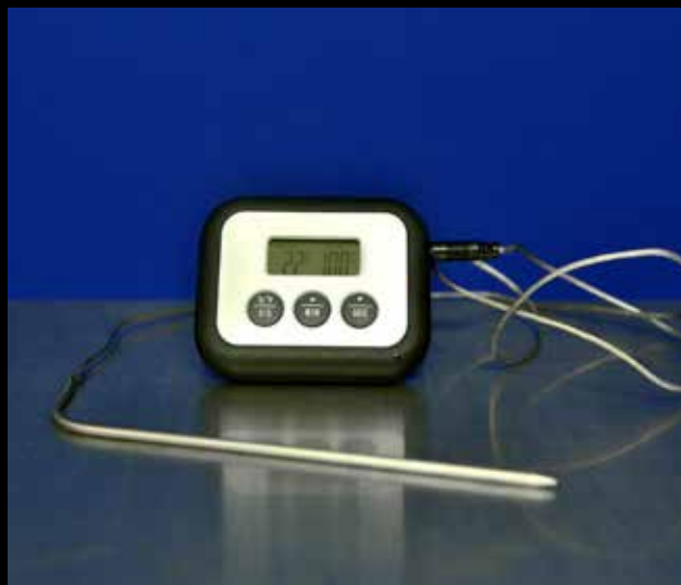
70. Termometro per la verifica del trattamento termico
